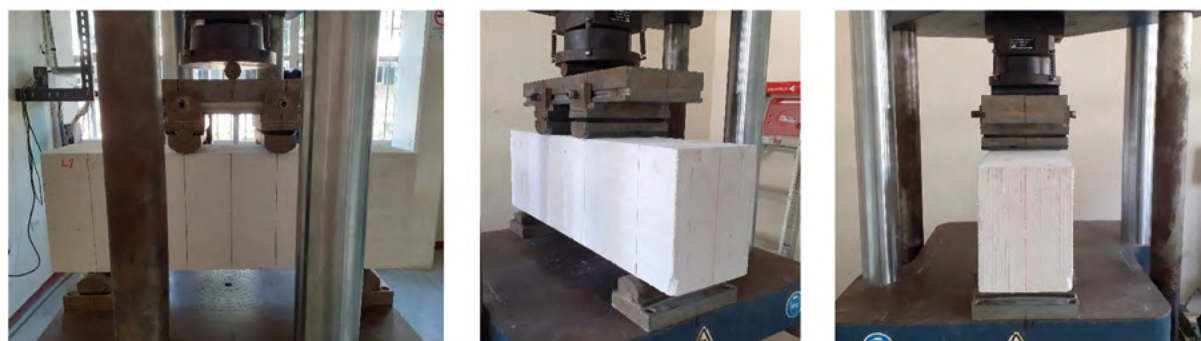
Figura 3. Ensayo a tensión por flexión de un bloque de CCA
