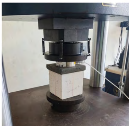
Figura 1. Ensaye a compresión de un cubo de CCA
