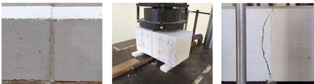
Figura 5. Ensayo a tensión por compresión de un espécimen de CCA
