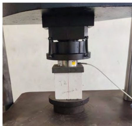
Figura 1. Ensaye a compresión de un cubo de CCA
