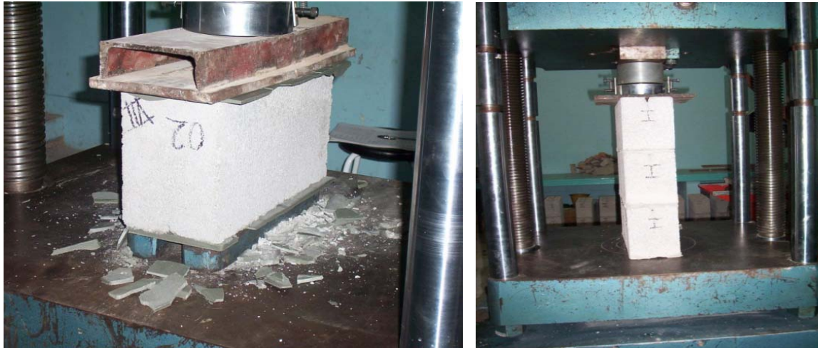
Figura 1: Aplicación de carga axial en las piezas y en pilas
